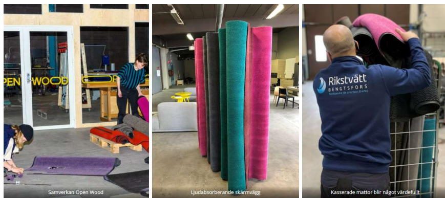
Figur 4. Genom samarbete med Textilt återbrukscentrum och Open Wood skapades ljudabsorberande skärmväggar av kasserade entrémattor.
