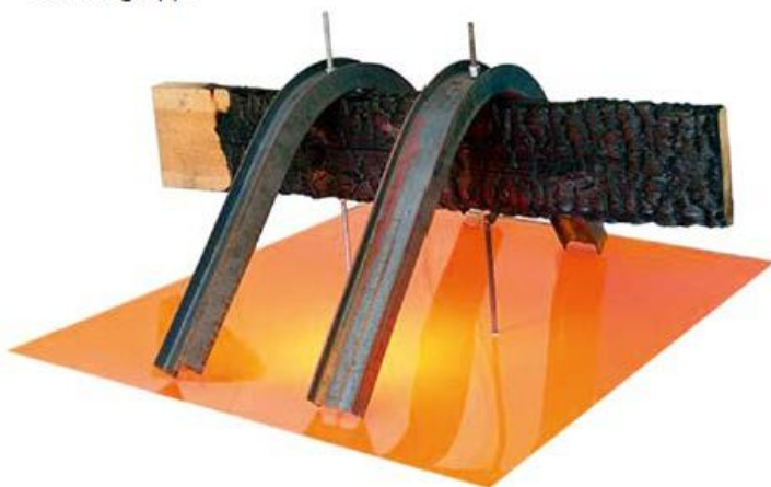
Figur 93 Limträ bibehåller en betydande bärförmåga även under en brand. Det skyddande kolskiktet som bildas på den förbrända ytan bidrar till detta. Bilden åskådliggör ett limträtvärsnitt före brand (till vänster), efter 30 min brand (mitten) samt efter 60 min brand (till höger) vid fyrsidigt brandangrepp.
